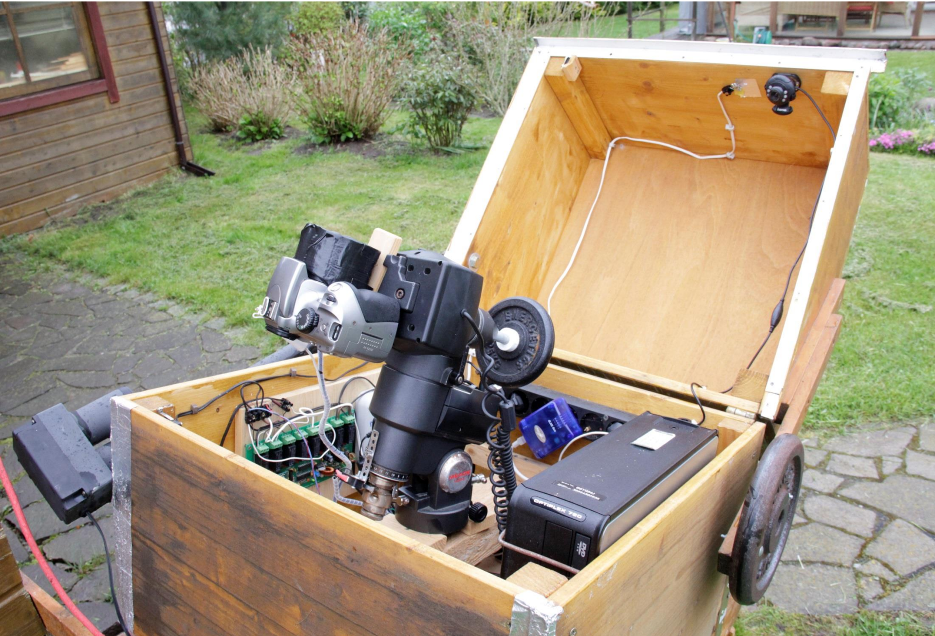
Meade LX55 Montierung Canon EOS 300D f=50mm f/D=1,9 XP PC PowerLine
